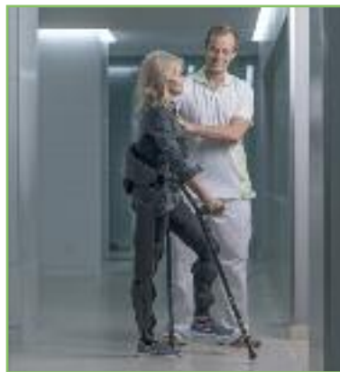
Abbildung 5: Robotisches Exoskelett «Indego» (Parker Hannifin, USA) zum mobilen Gangtraining. Der Patient bewegt sich mit dieser Kombination von Steuereinheit, Orthesen, Aktuatoren und Batterie im Gangzyklus fort. Er kann hierbei die Bewegung initiieren und Gangparameter wie Geschwindigkeit und Schrittlänge selbst steuern.
