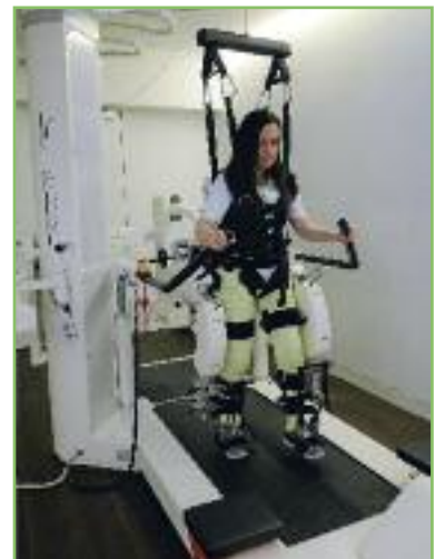
Abbildung 4: Der Exoskelett-Gangtrainer «Lokomat» (Hocoma, Schweiz). Er unterstützt mittels Orthesen und Aktuatoren den Gangzyklus in Hüft-, Knie- und teilweise im Sprunggelenk. Eine dynamische Körpergewichtsentlastung und in neueren Versionen ein zusätzlicher Versatz und eine Drehung des Beckens ermöglichen ein nahezu physiologisches Gangmuster.
