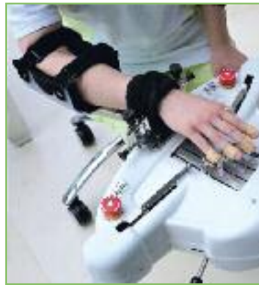
Abbildung 1: Exoskelett-System «ArmeoPower» (Hocoma, Schweiz) für die Therapie des Arms. Die Armbewegung wird über alle Freiheitsgrade von Schulter, Ellenbogen, Unterarm, Handgelenk und der Finger trainiert. Die tatsächlich mögliche Bewegung der paretischen Extremität wird sensorisch erfasst, dabei wird nicht mehr Unterstützung als nötig gegeben.
