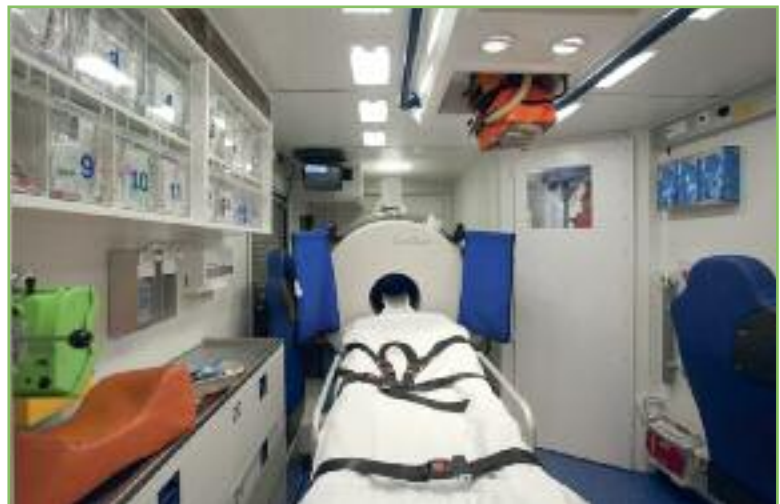
Abbildung: Innenansicht des STEMO: Computertomograf am Kopfende. 1,2,3Schutzraum mit Point-of-Care-Labor auf der rechten Seite.
