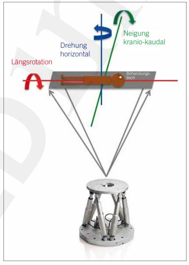
6-Achsen-Hexapode: 6-Achsen-Hexapode sind in der Robotik gängige Steuereinheiten, die neben Längs-, Quer- und Höhenkorrektur (x-, y- und z-Achse) auch Rotationen längs, Kippung kranio-kaudal und Drehungen horizontal ausgleichen können.
