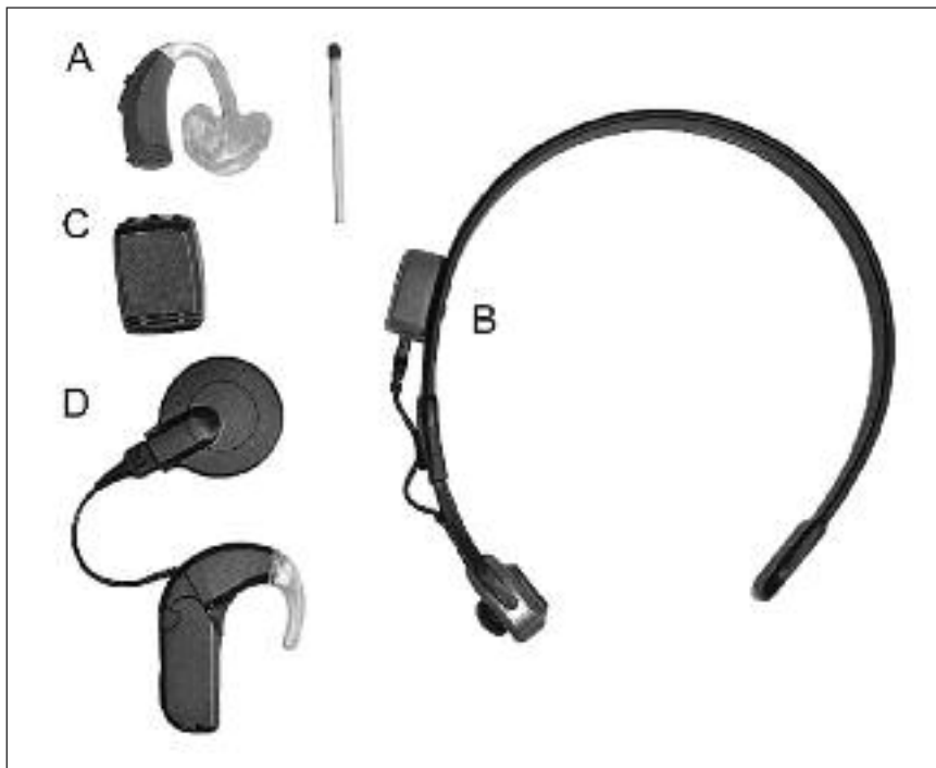
Abbildung 2: Beispiele einiger Hörhilfen (nur extern getragene Teile). A: konventionelles Hinter-dem-Ohr-Hörgerät; B: Knochenleitungshörgerät, hier an einem Tragebügel. Alternativ wird häufig ein textiles Kopfband zur Befestigung benutzt; C: knochenverankertes Hörgerät (Baha); D: Sprachprozessor eines Cochleaimplantat-Systems mit Sendespule. Größenvergleich: Das Streichholz ist 5 cm lang.
