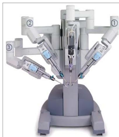
Abb. 4: Eigentlicher Roboter mit vier Roboterarmen (ein Arm für die Kamera, zwei Arme für die eigentlichen Operationsinstrumente und ein Arm als Haltearm)
